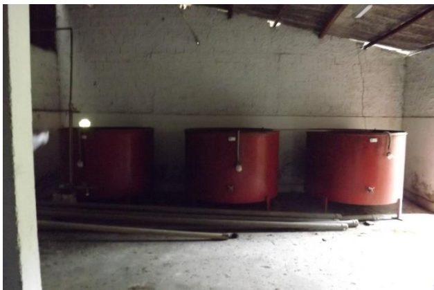
Detalhes dos recipinets de resfriamento no fabrico de cachaça - Comunidade de Retirada
